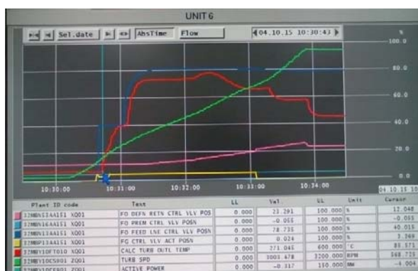
شکل شماره (۴) : منحنی در صد کنترل ولو گازویل با سه رمپ (منحنی صورتی رنگ)
