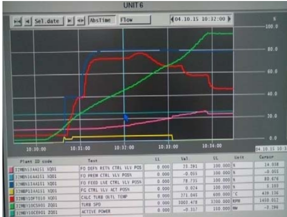
شکل شماره (۱) - منحنی زرد رنگ Start Position دو پله ای کنترل ولو گاز در استارت با سوخت گازوییل
