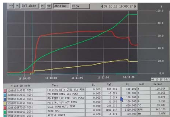
شکل شماره (۲) : منحنی دوپله ای Start Position کنترل ولو سوخت گاز در استارت با گاز
